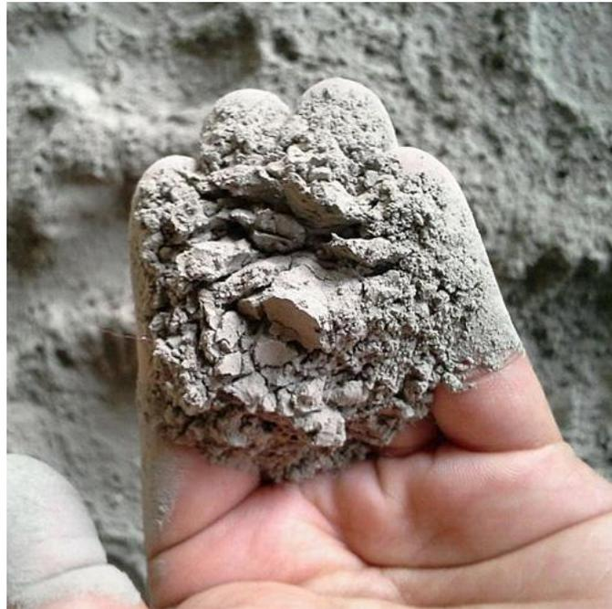
水泥是一种粉状水硬性无机胶凝材料，加水搅拌后成浆体，能在空气中硬化或者在水中更好的硬化，并能把砂、石等材料牢固地胶结在一起，多用于土木工程、水利、国防等工程，其历史可追溯到古罗马人在建筑工程中使用的石灰和火山灰的混合物。自 1824 年英国人阿斯普丁 ( Joseph Aspdin ) 发明现代水泥配方至今已经有 180 多年的使用历史，在制造和使用方面都已经十分成熟。
